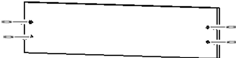
19. З'єднай деталь 20.16.07 з конструкцією, закрути ексцентрики мініфіксів.
