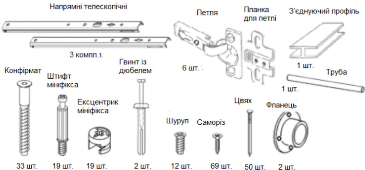
1. У вказані отвори деталей 20.16.13 і 20.16.14 прикрути одну частину телескопічних напрямних за допомогою шурупів.
